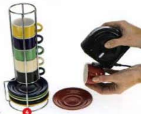
4 Kleuren meten in L.a.b. en RGB met de spotmeting van de ColoMunki.
